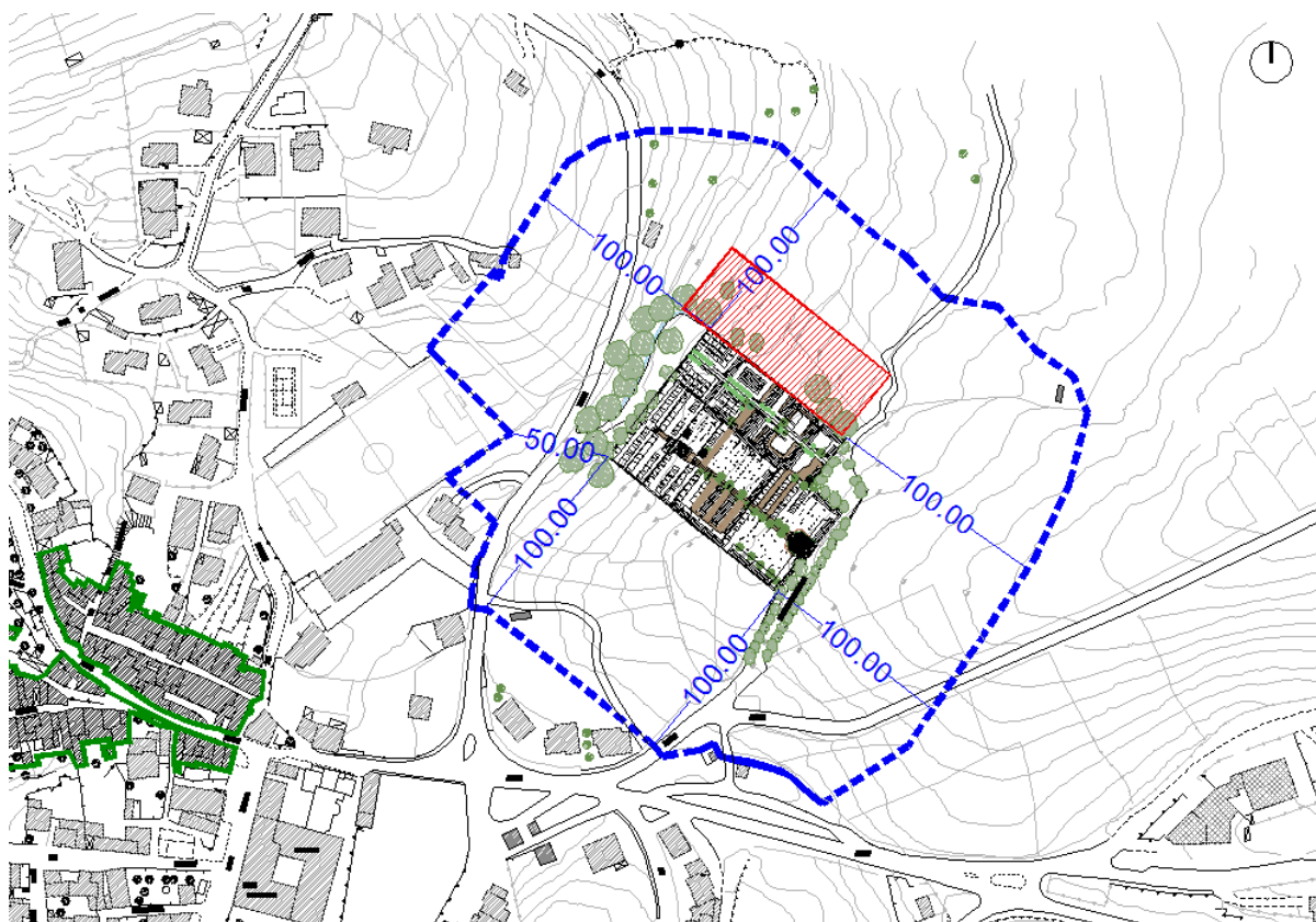
Figura 9 Fascia di rispetto cimiteriale esistente
