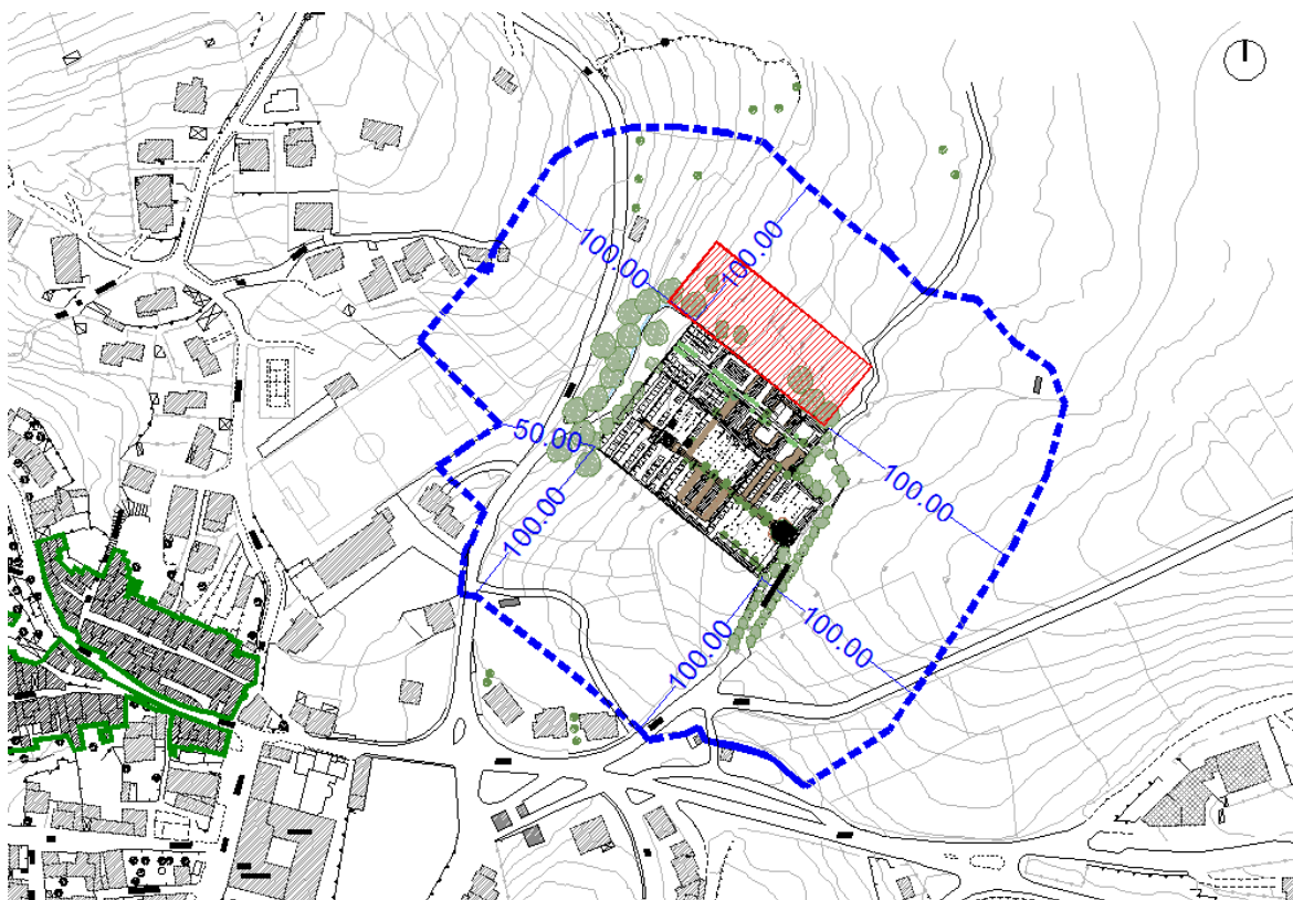
Figura 8 Fascia di rispetto cimiteriale esistente
